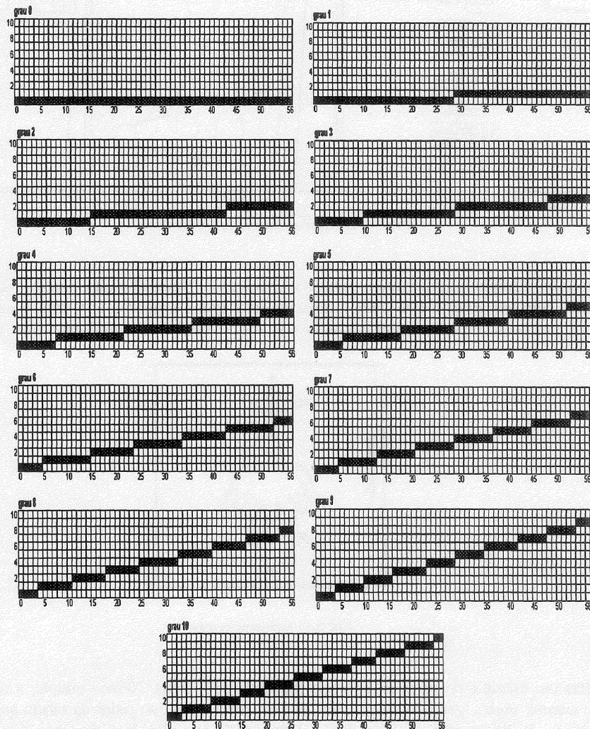
Fig.4 – Família de elementos estruturantes entre 0 e +10 graus.
